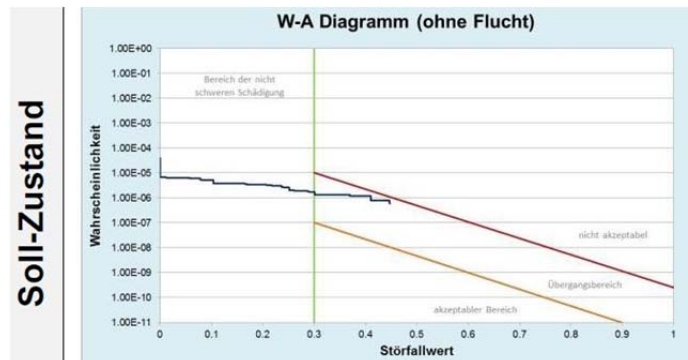
Abbildung: W-A-Diagramm zur Ammoniakanlage mit Projekt, ohne Massnahmen
