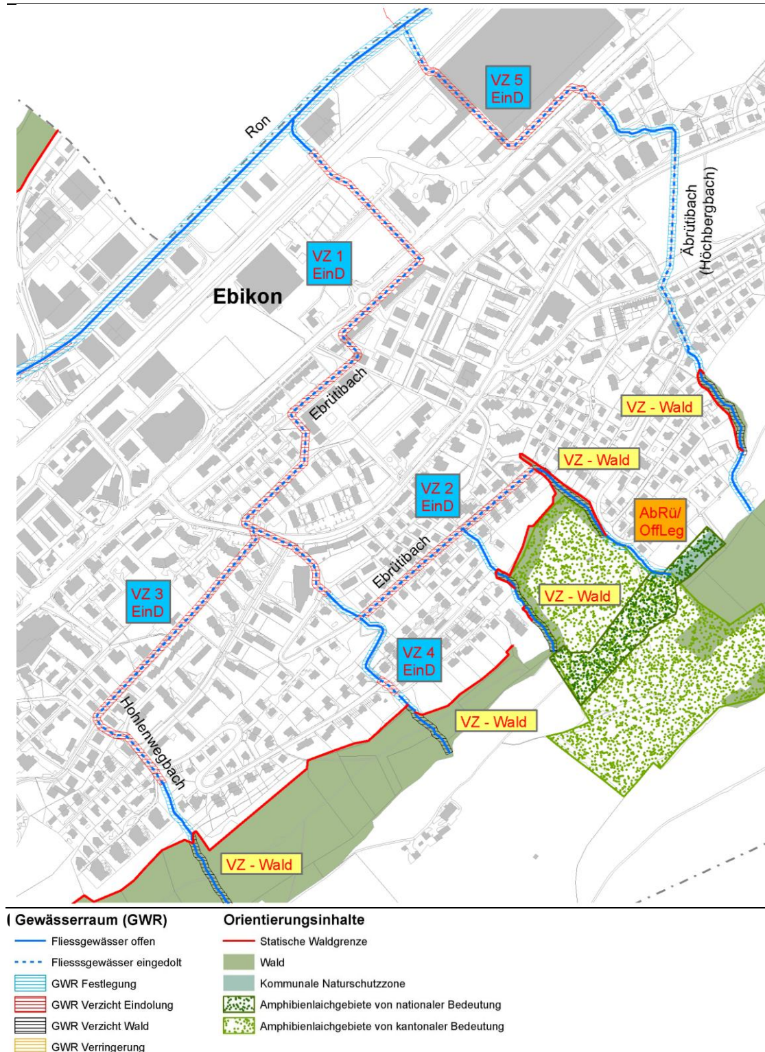
Abb. 22: Übersicht Verzicht Gewässerraumfestlegung (VZ) sowie kein Verzicht und asymmetrische Festlegung (AbRü/OffLeg).
