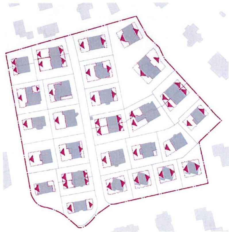
Richtung für bauliche Erweiterung, Ergebnis der Fallstudie
